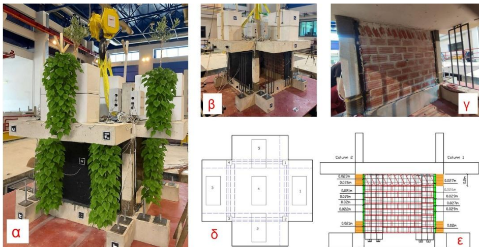
Εικόνα 2. Μονώροφο κτήριο μετά τις ολοκληρωμένες επεμβάσεις για την εφαρμογή ΚΔ, α) φωτορεαλιστική απόδοση της επέμβασης, β) άποψη του δοκιμίου, γ) εσωτερικό του δοκιμίου με εστίαση στα περιτυλιγμένα κορδόνια, στον αντισεισμικό αρμό πολυουραιθάνης (PUFJ) μεταξύ τοιχοποιίας και υποστυλωμάτων και το χαλύβδινο προσομοίωμα των κάθετων τοίχων φυτοκάλυψης, δ) θέσεις των 5 φυτοδοχείων στο δώμα και εξώστες, ε) εξωτερική όψη με τις δομικές επεμβάσεις ενίσχυσης
